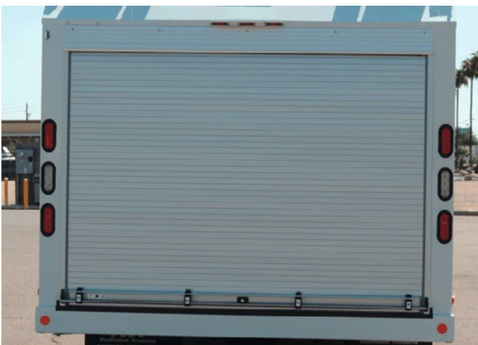
Rolltüren für Laderaum/ Roll-up compartment doors
