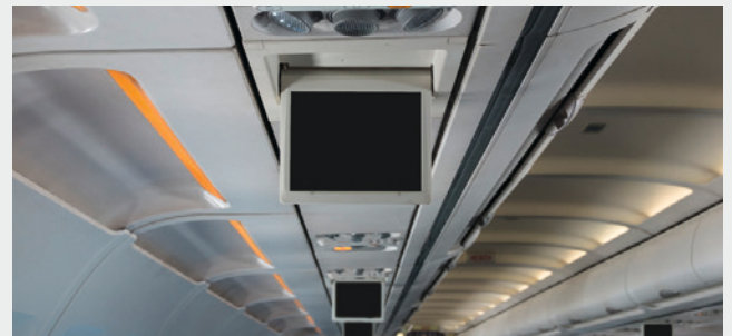
Beim Ausfahren der Monitore verhindern Rutschkupplungen Schäden am Antriebssystem oder Verletzungen der Passagiere/ A slip clutch prevents drive system damage or passenger injury in the event the screen is obstructed
